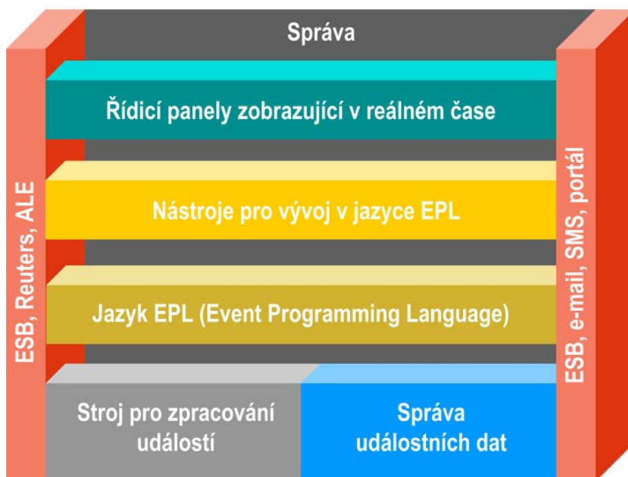
Obr. 3: Příklad architektury CEP
