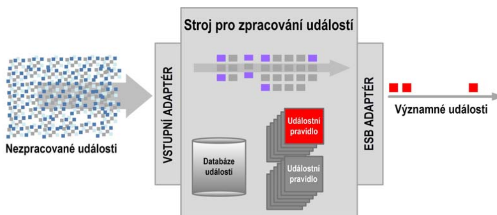
Obr. 2: Schéma komplexního zpracování událostí pomocí korelátoru
